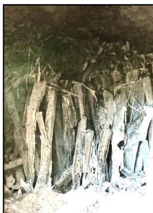
開封時の初見では画像のとおり、前列部の炭材は燃焼・灰化していたが、残っているものでは良好な炭化が進んだように見受けられた。
